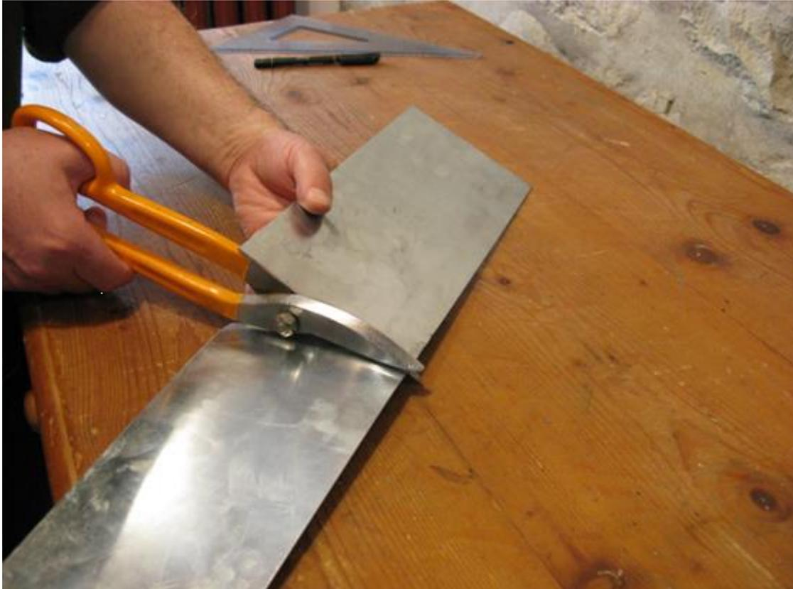
Per l'utilizzo della cesoia come strumento per tagliare la lamiera (spessore massimo mm.1), si deve procedere segnando la linea di riferimento a misura con l'uso di un pennarello indelebile. Tenendo questo riferimento si appoggia la lastra su un piano e premendo con forza, ma senza completare la chiusura delle lame, si esegue il taglio. N.B. Completando la chiusura del taglio si rischia di deformare la linearità della lastra.
