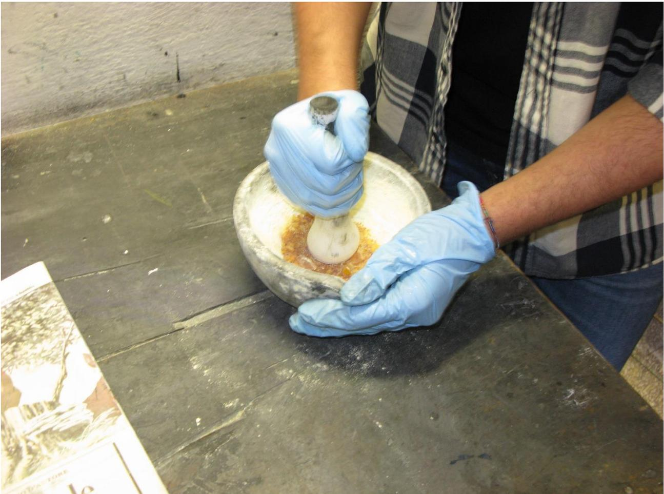
La colofonia può essere polverizzata manualmente utilizzando un mortaio.
