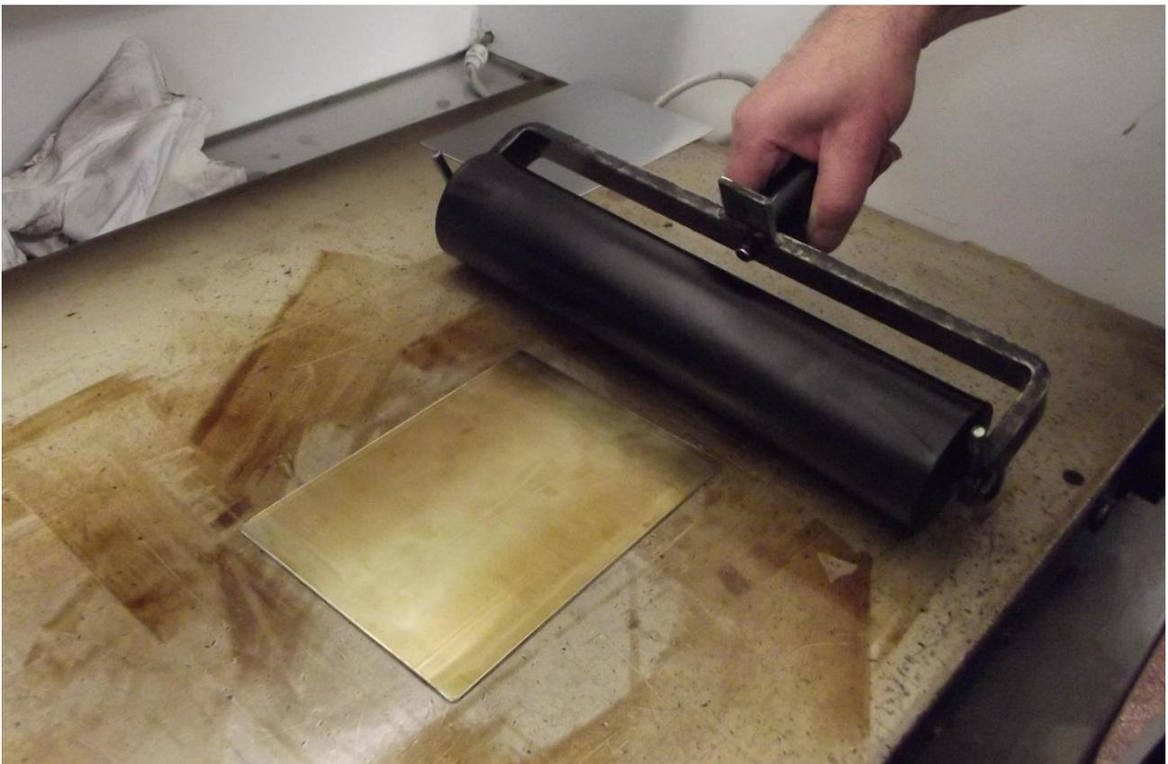
Posiziona la lastra sul piano caldo e strofina la vernice in coni dura sulla parte pulita. Usa un rullo per stendere la vernice in modo uniforme su tutta la superficie.
