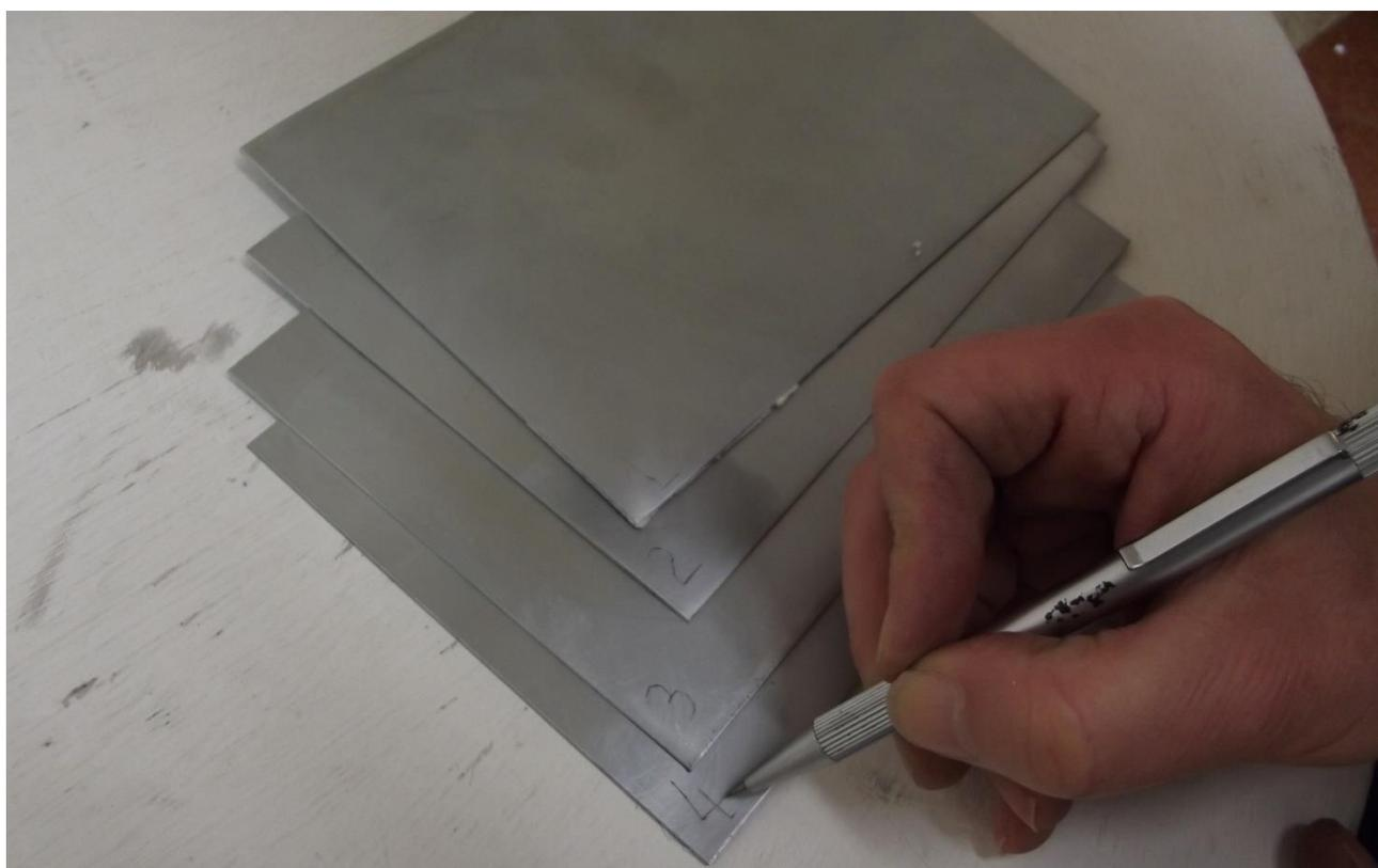
Le lastre devono essere in microzinco o rame con dimensioni e spessore uguali per poter essere sovrapposte durante la stampa. Sul retro di ciascuna lastra, sulla sinistra della base, è necessario incidere un punto di riferimento con una punta, ad esempio 1, 2, 3, 4 oppure giallo, rosso, blu, ecc.
