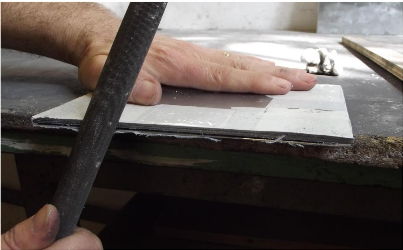
Per pareggiare le lastre con precisione, sovrapponetele facendo corrispondere il punto di riferimento inciso sul retro. Fissatele con nastro adesivo e utilizzate una lima per pareggiare un lato della lastra senza rimuovere il nastro adesivo.
