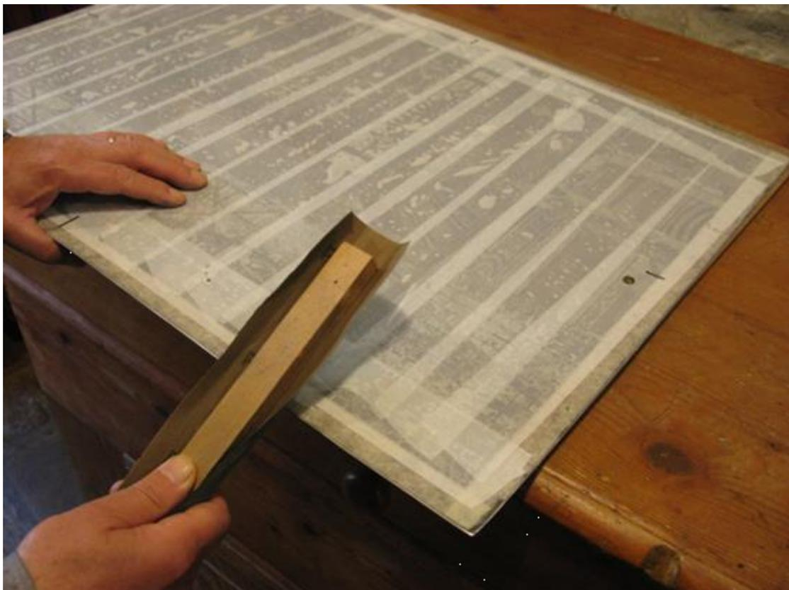
Per lisciare i bordi e gli spigoli della lastra, posizionare il bastoncino di legno rettangolare con la carta abrasiva in modo corretto e passare delicatamente sulla superficie.
