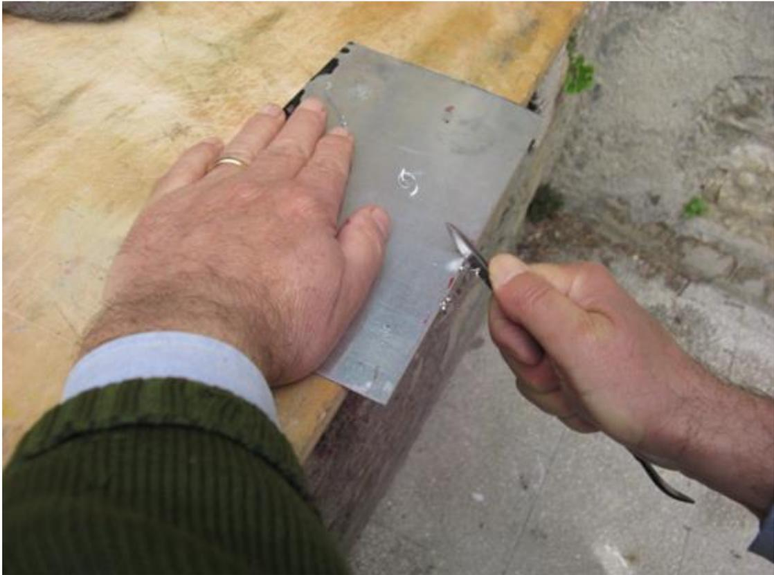
Si prosegue con la preparazione della lastra per ottenere il giusto supporto idoneo all'uso; impugnare quindi un raschietto a tre tagli, lavorando in modo fluido e deciso. Raschiare con un'inclinazione di 45 gradi ripetutamente per limitare i bordi vivi.
