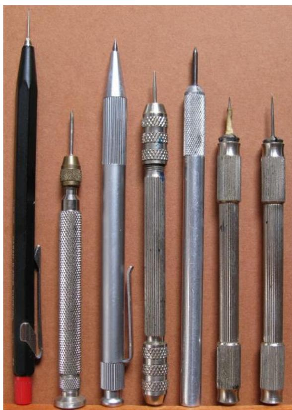
Precisazioni per quanto riguarda le punte: Con delle buone punte è più facile incidere direttamente le lastre. Il portamine delle immagini precedenti, non è altro che un ago spessorato con del nastro da carrozziere.
