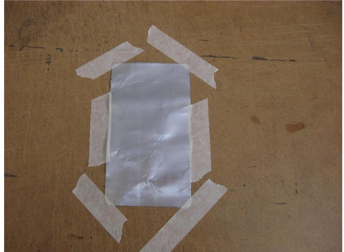
2 Dopo avere impostato le misure con una riga o una squadretta, rifilare bene i lati sempre con la forbice. Fissare il lamierino su un piano, (faesite cartone ecc.) con del nastro da carrozziere o con del nastro adesivo.
