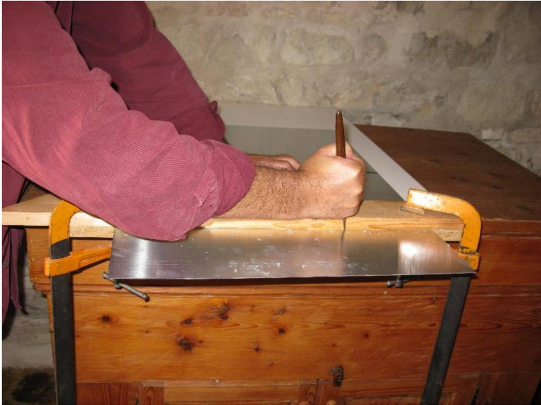
1 Per poter tagliare le lastre senza l'ausilio della trancia a pedale, bisogna fissare su un tavolo una lastra di zinco, di plexiglass o di rame (spessore massimo mm.1) con un listello di legno e dei morsetti. Procedere tracciando, con una punta robusta, un segno, prima leggero e poi via via sempre più forte.
